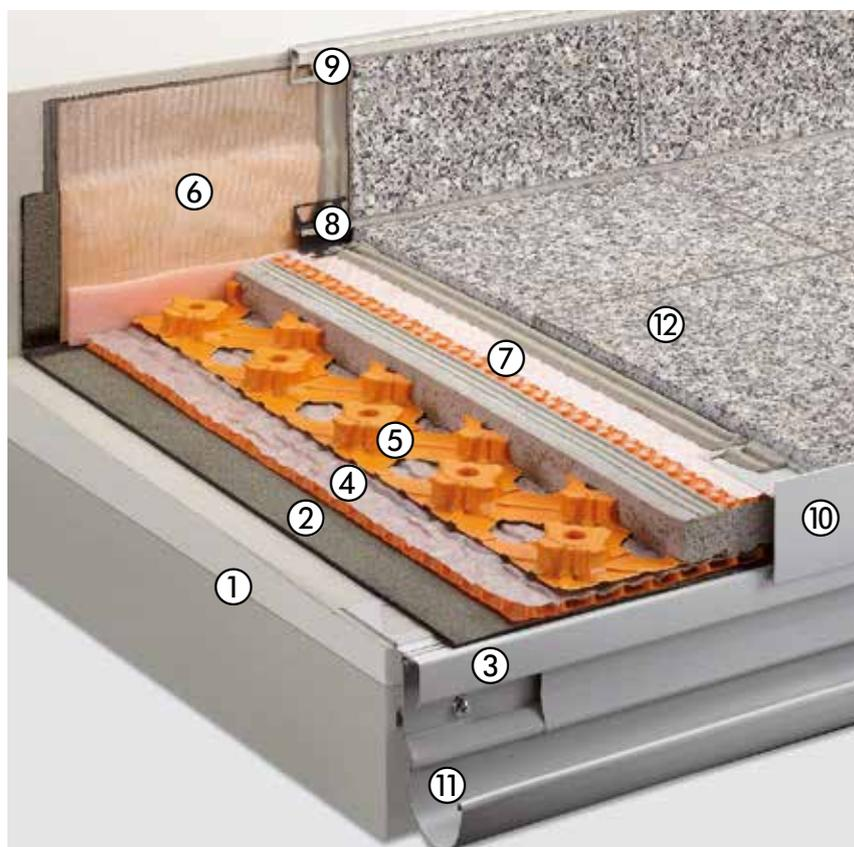
A construção portadora é protegida por uma impermeabilização DIN 18195. Entre esta impermeabilização e o pavimento de camada fina Schlüter®-BEKOTEC-DRAIN é colocado Schlüter®-TROBA-PLUS como drenagem. O conjunto de drenagem com capilares de passagem Schlüter®-DITRA-DRAIN produz uma ventilação por baixo de toda a superfície do revestimento e assim consegue-se um endurecimento mais rápido e uniforme da camada fina de cimento cola.
